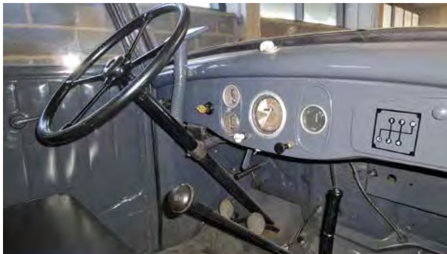
Kölnin Fordin ohjaamo on varsin pelkistetty. Entisöinnissä jouduttiin jopa valmistamaan virta-avain. Huomaa suuntanuolien katkaisija keskellä kojelautaa tuulilasin alla. Vaihteisto on muuten synkronoimaton.
